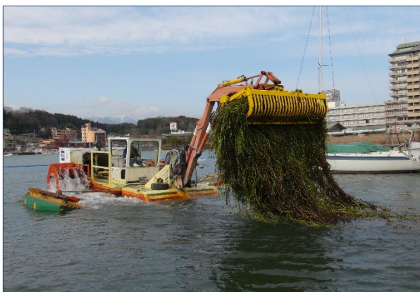
[大量繁茂した水草の除去作業]
