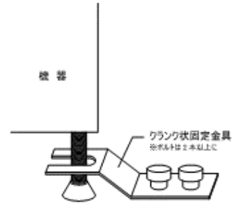
各種機械・設備の固定の例
