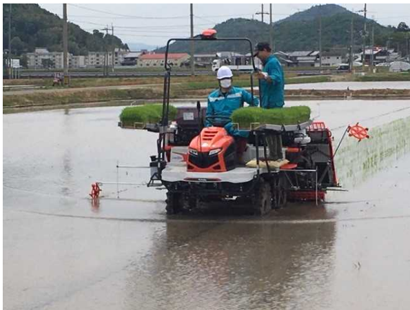
188 深い水深でも田から水を落とさずに田植えができる 189 自動直進田植機による田植えの実証
