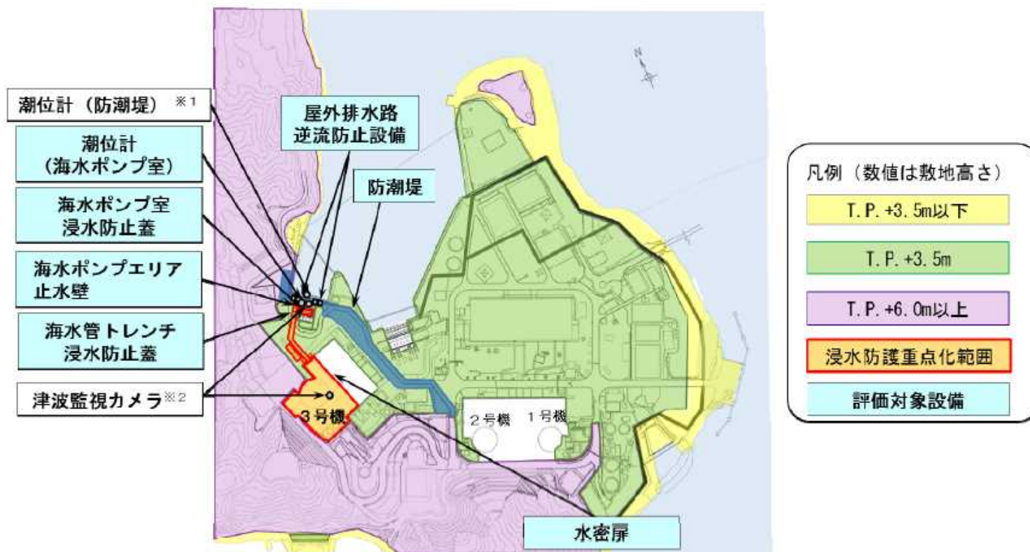
美浜発電所の耐津波安全性評価対象設備
