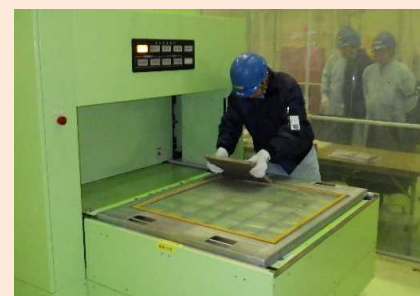
CLモニタトレイに解体金属を設置
