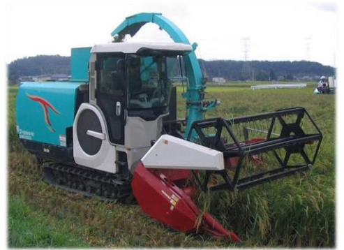
汎用型飼料収穫機を利用した コントラクターによる稲WCSの収穫
