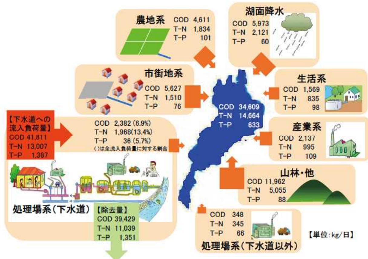
注) 除去量については、処理場系（下水道）のみ算出しています。
