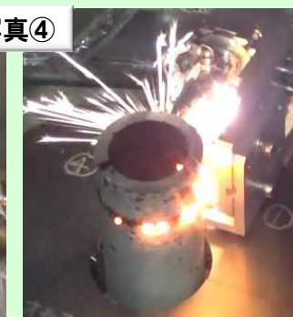
実機配管へのレーザー切断の適用実証
