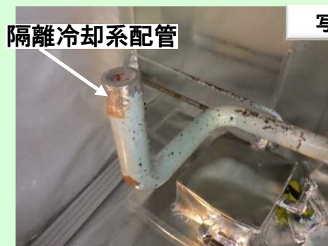
実機配管へのレーザー切断の適用実証
