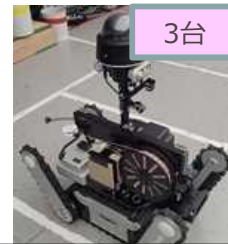
無線操作 小型ロボット [情報収集・軽作業]
