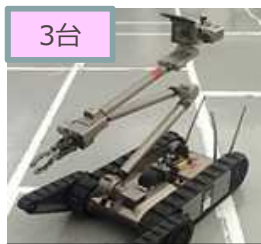
無線操作 小型ロボット [情報収集・軽作業]
