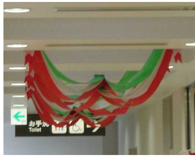
店舗看板等により、必要な案内設備が見えにくくなっています
