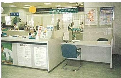
通常の高さのカウンターと、車いすのフットレストが入る構造の2種類のカウンターが設置されています
