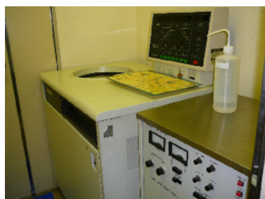
（写真：研究テーマの都合より平成21年度使用実績なしの分離用超遠心機 19,700千円（1986年度購入））
