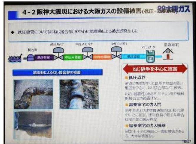
各家庭への低圧導管に被害が集中しました。
