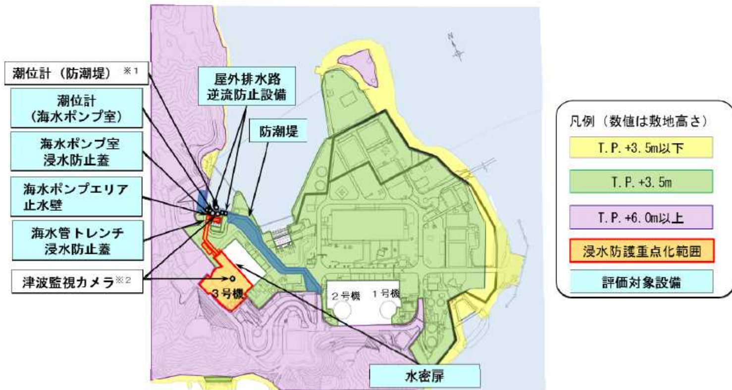
美浜発電所の耐津波安全性評価対象設備
