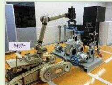
バルブの開閉操作
