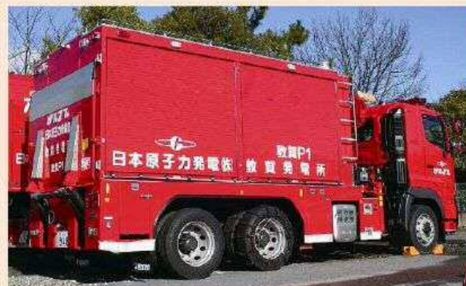
可搬型代替注水中型ポンプ
