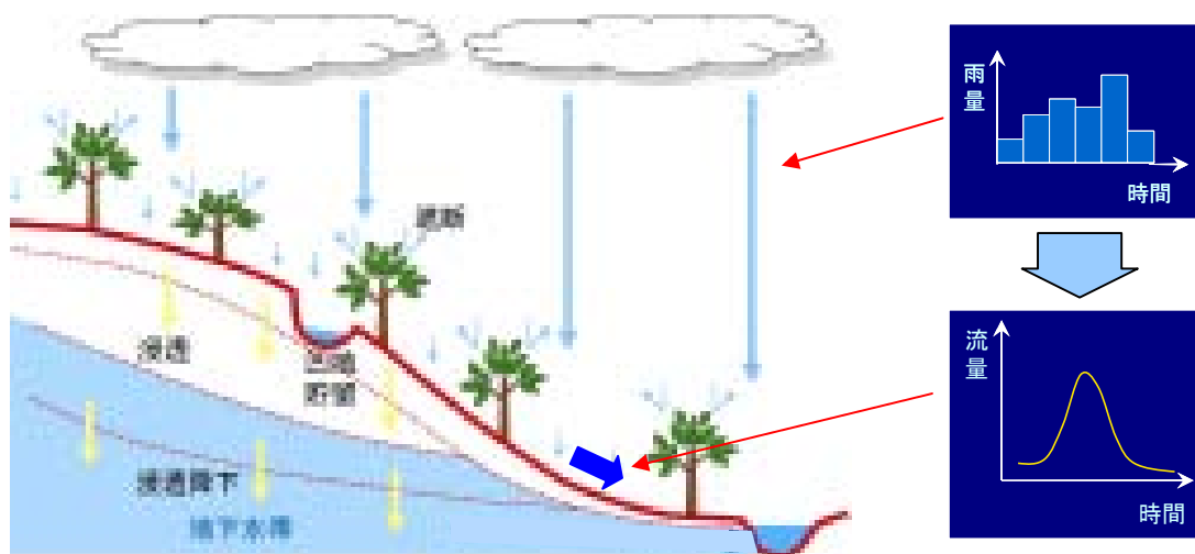
図 2.5.2 統合型水理モデルにおける山地からの流出計算イメージ
