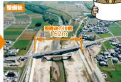
日野川では、工事の結果、1.3倍の水を流せるようになりました。
