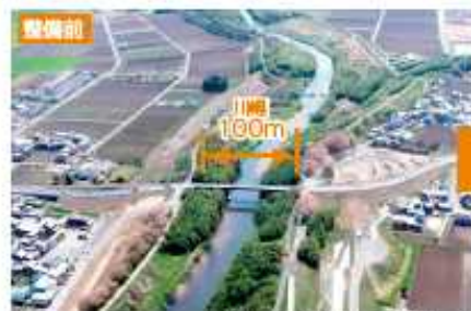
日野川では、工事の結果、1.3倍の水を流せるようになりました。
