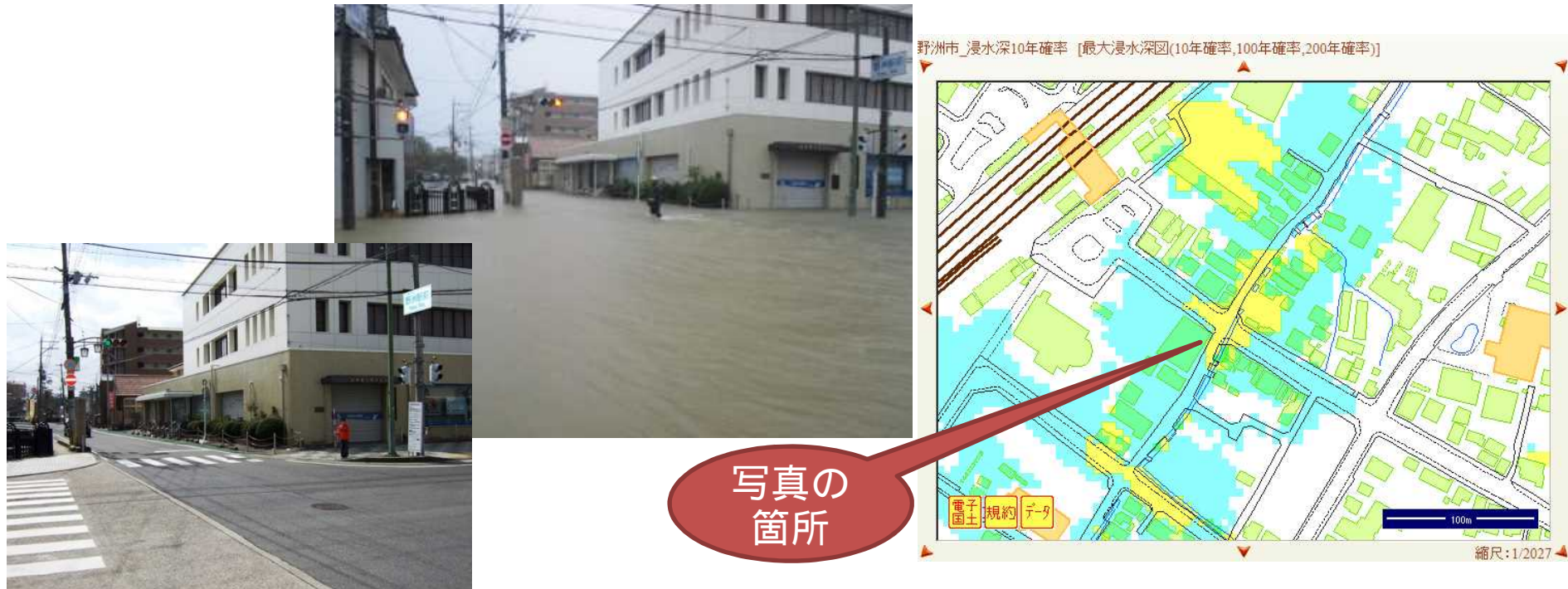
左:平常時、中央:平成25年台風18号時浸水状況(最大時間雨量 37mm) 右:地先の安全度マップ(1/10,最大時間雨量50mm)
