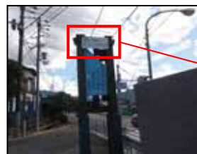
移動中の車両から確認できる場所に避難誘導標識を設置した例
