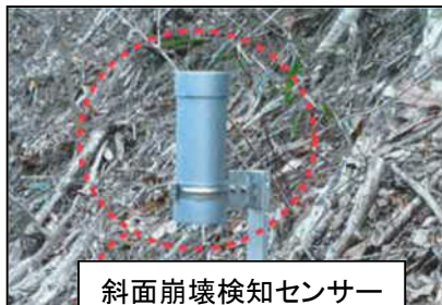
③ワイヤセンサー、斜面崩壊検知センサーによる土石流の監視
