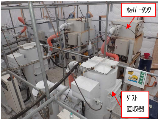
写真-2 循環式エコクリーンブラスト装置(3セット)
