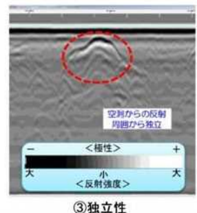
図-3 空洞からの反射条件の特徴
