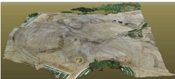
図-9 UAVによる航空写真を用いた3D図面
