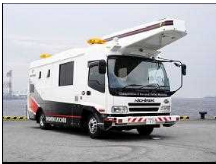
写真-1 路面性状測定車
