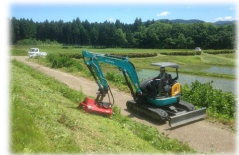
バックホウに取り付けたモアで効率的かつ安全な急傾斜地の草刈り作業
